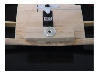
Balsastrebe (Länge = Rumpf-Innenbreite) zuschneiden und mittig die Einschlagmutter einkleben.
