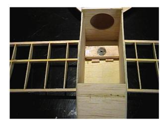
Fläche ausetzten, ausrichten und die Strebe seitlich an der Rumpfwand verkleben.
