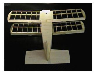
Querruder durch verschieben des Drahtes im Röhrchen ausrichten.
