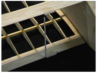
In den oberen Draht ganz leichte Biegungen einbiegen. So klemmt der Draht in dem Röhrchen und kann nicht verrutschen, die Flächen sind aber jederzeit durch Auseinaderziehen dieser Verbindung zu demontieren.
