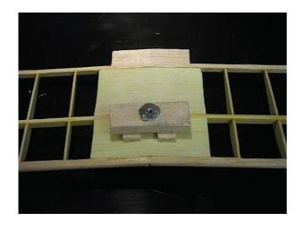
Strebe anfertigen (Länge = Innen-Rumpfbreite), Einschlagmutter einkleben und Strebe mit zwei 3mm Abstandshaltern mit der Fläche verschrauben.
