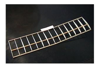
Auf einem planen Baubrett die Flächen mit Spanten und Leisten zusammenkleben. Dazu die Rippen gleichmäßig über die Spannweite verteilen. Die Wurzelrippen im Abstand der Rumpfbreite verkleben, so daß sie später auf dem Rumpf aufliegen.
