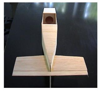
Das Höhenruder hat eine Breite von 15 mm. Dazu einen Streifen aus dem Arbeitsbrett ausschneiden, an der Scharnierseite 45 Grad anschleifen und mit einem Tesa-Streifen ankleben.
