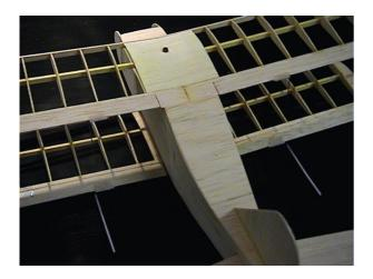
Bowdenzugröhrchen ablängen (ca. 5 mm kürzer als der Abstand oberes<->unteres Querruder) und auf dem unteren Draht mit dünnen Sekundenkleber festkleben.
