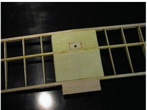
Mit der oberen Fläche genau so verfahren. Dazu einen Balsa- oder Sperrholzklotz in die obere Fläche einkleben und 3,5 mm bohren.
