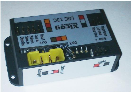
Verbinden sie die Kabel der Bremsen mit den mit „Brake“ gekennzeichneten Buchsen. Auf richtige Polarität muss hierbei nicht geachtet werden.
